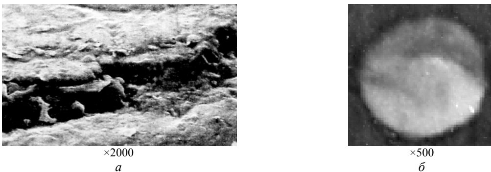
Рис. 1. Фрагмент покрытия (а) и дефект в виде капельной фазы (б)
