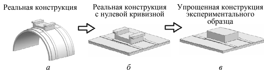
Рис. 1. Анализ упрощения формы реальной конструкции до экспериментального образца
